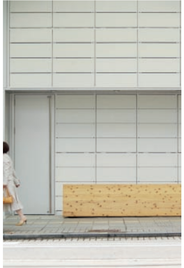
作品名 : 県産杉間伐材ベンチ 寸法 : W 3,240 × D 350 × H 700 mm 素材・仕上 : 杉間伐材、オイルフィニッシュ 制作年 : 2008年 制作 : 設計工房M and M、タカハタ工業 設置場所 : 高岡駅前末広通り
