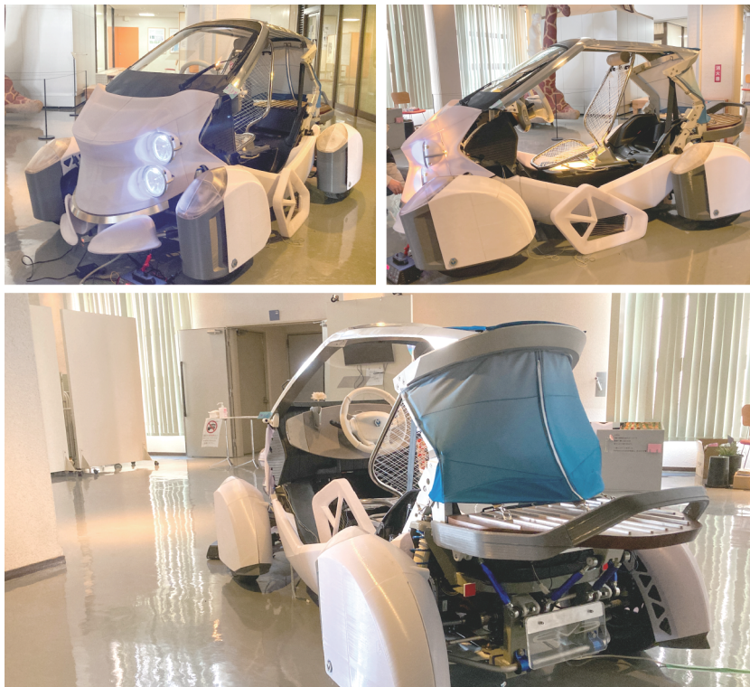
モビリティデザイン／アルミニウム、PETG樹脂／h1374×w1385×d2856mm
