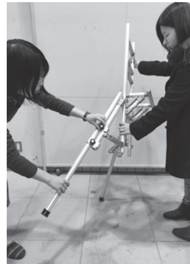
図3.アルミ製背負梯子製作風景
