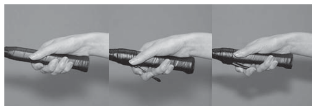
図1. 補助具なし（左）、固定式補助具（中）、可動式補助具（右） ※可動式補助具は固定式補助具と同じ角度で付いており、握るとグリップに密着する。
