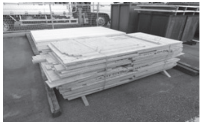
図2. 結束された厚物合板端材
