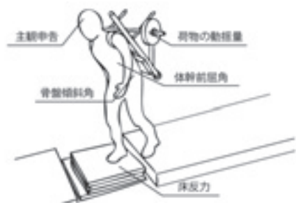
図2. 実験の様子と測定項目
