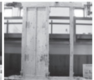
写真2. 耐力壁のせん断試験
