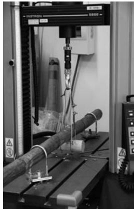
写真1 竹材および竹材接合部の曲げ試験風景
