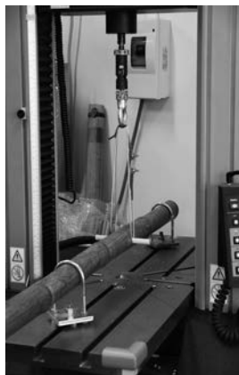
写真2 竹材および竹材接合部の曲げ試験風景
