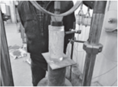
写真3) 圧縮試験の様子／著者撮影(2017)
