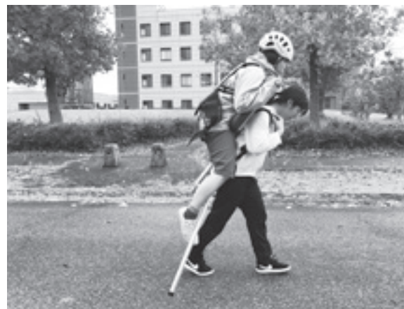
図1. アルミ製背負梯子使用時の様子
