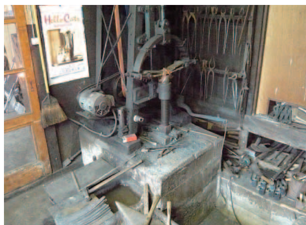
図2 鍛造エリア北東側 写真中央にベルトハンマーが据付けられ、その右側壁にかけられた火箸、左側には水槽、右手前に横座穴がある。
