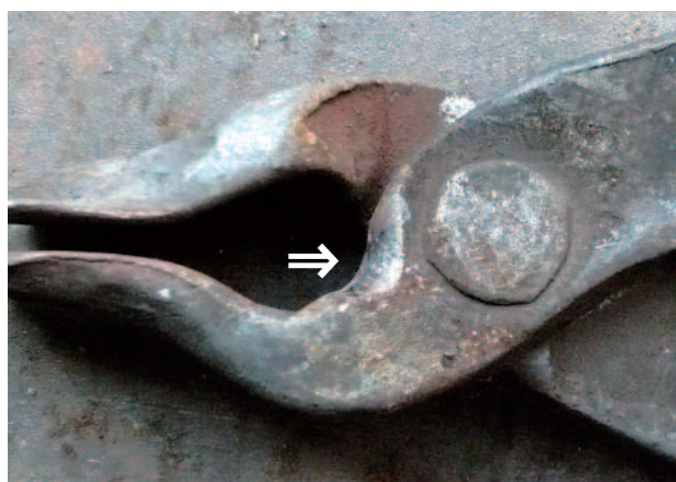
図8 火箸 掴み口の元の部分に磨り減った痕跡がある（矢印の部分）。
