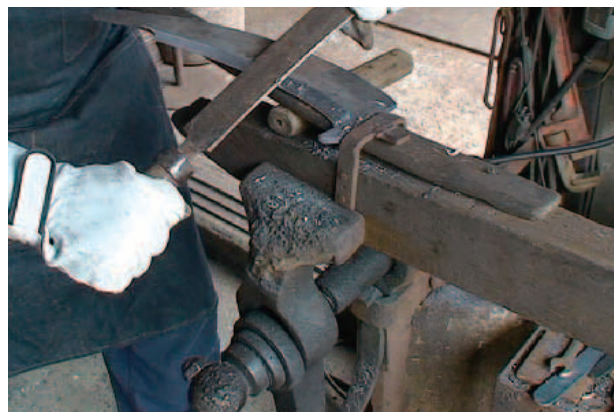
図12 鑿による切削状況（鑿掛け） 縦万力に固定した鑿掛け台の上で、泊鉈の刃シノギを鑿によって切削する。トンビやナカゴ（被切削物先端）を固定台中央にある鉤型帯に挿し込み、固定する。
